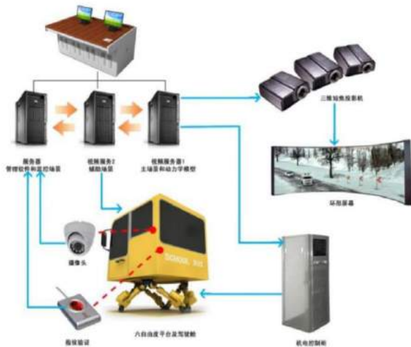
图 24: 大型车辆安全驾驶模拟训练系统
